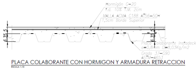
Figura 4: "Detalle de placa colaborante".
