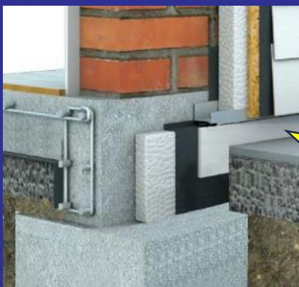
*Si no se contempla sobreimiento, el elemento que cumpla la función de separar el nivel de piso terminado de la edificación y sus muros perimetrales del nivel del terreno, deberá cumplir esta misma exigencia.*
