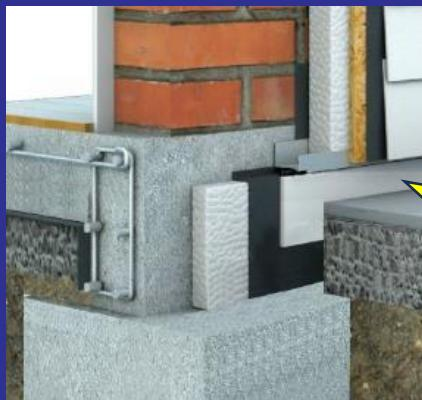
*Si no se contempla sobrecimiento, el elemento que cumpla la función de separar el nivel de piso terminado de la edificación y sus muros perimetrales del nivel del terreno, deberá cumplir esta misma exigencia.*
