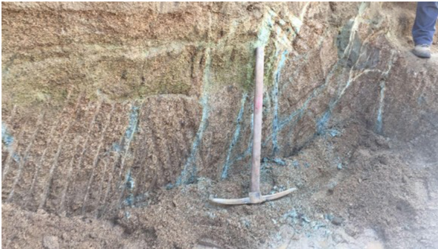
← Figura 35: Maicillo con presencia de estructuras relictas y material de relleno en dichas estructuras (terreno ubicado en El Belloto, Región de Valparaíso).
