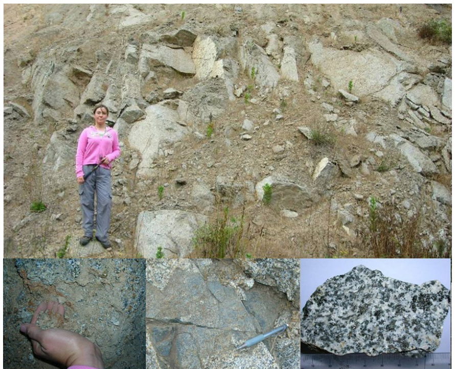
Figura 64: → En horizontes de saprolito y saprock (Grado IV y V), se observa que dicho límite es difuso debido a variaciones locales.
