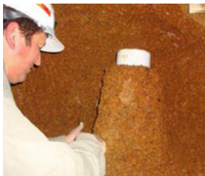
← Figuras 29: Tallado de probeta para triaxial en el sitio (Gentileza de Ingendesa)
