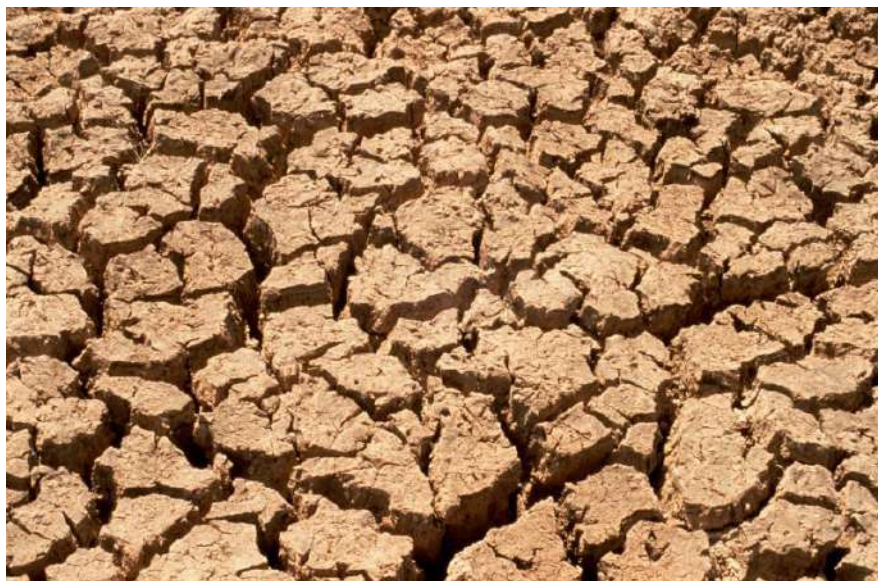
← Figura 5.2: Grietas de secado en arcillas expansivas
