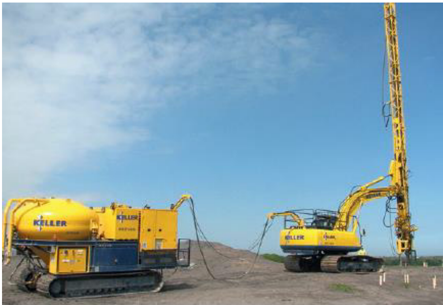
← Figura 6.7. Equipos para ejecución de dry soil mixing (Keller, 2018)
