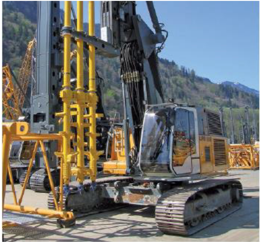
..... Figura 6.5. → Máquina para construcción de columnas suelo-cemento con múltiples ejes (Keller, 2018)
