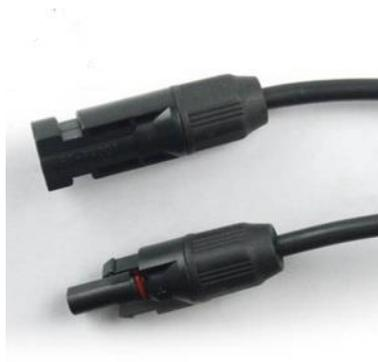
**8.5.** Los conductores positivo y negativo de los paneles, al conectarse paneles en paralelo deberán utilizar conectores tipo MC4 paralelo cuya capacidad es 50A, no se aceptan conectores tipo MC4 paralelos que soporten menos amperaje.
