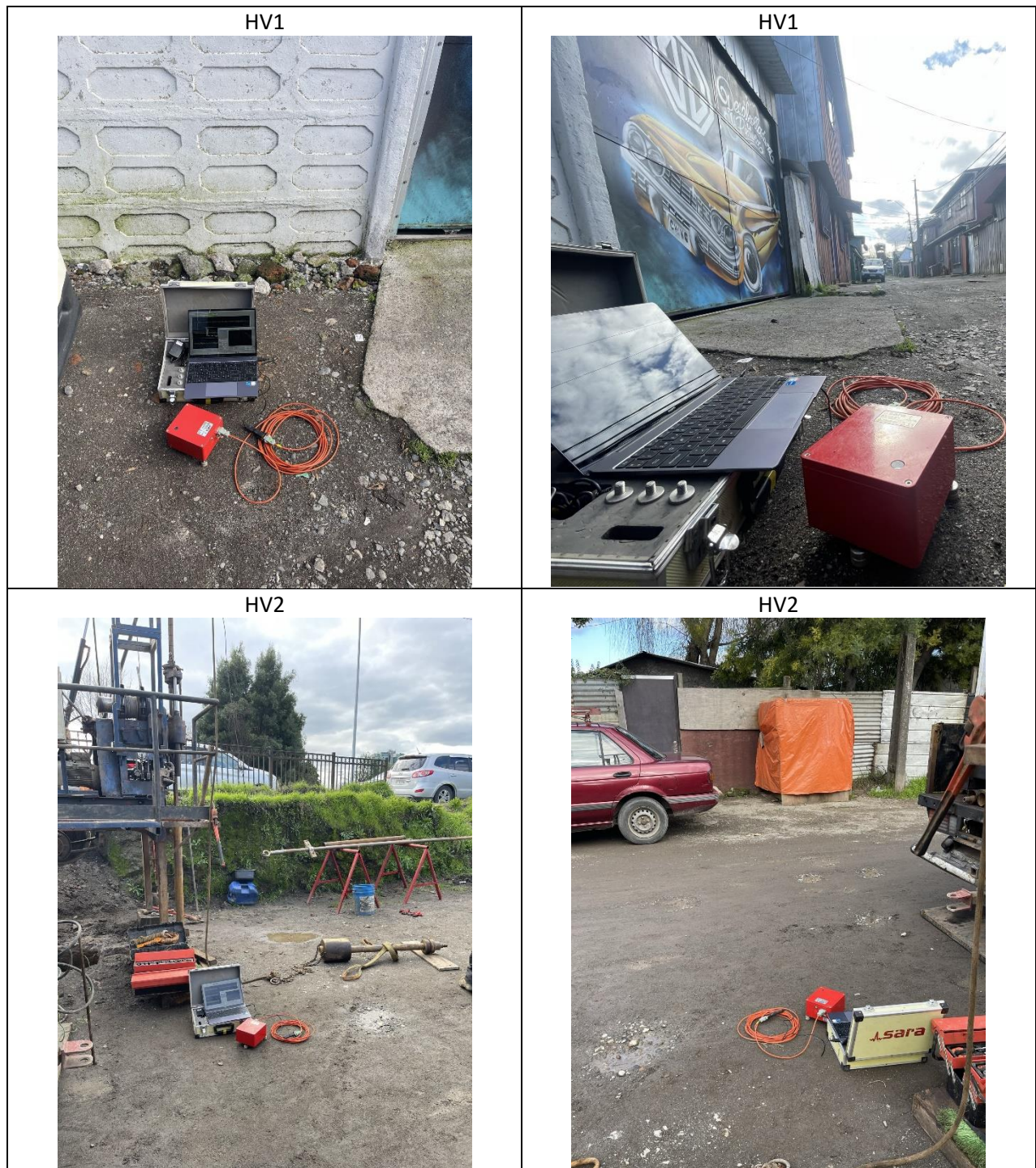
Figura 19: Fotografías de Mediciones Nakamura.
