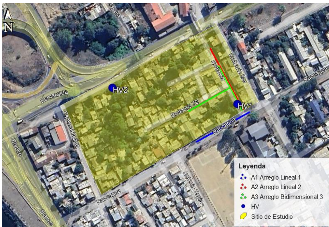
Figura 7: Esquema de mediciones emplazados en terreno, para mediciones de fuente activa, pasiva y medición de vibraciones ambientales en 3 ejes HV en Sitio de Estudio.
