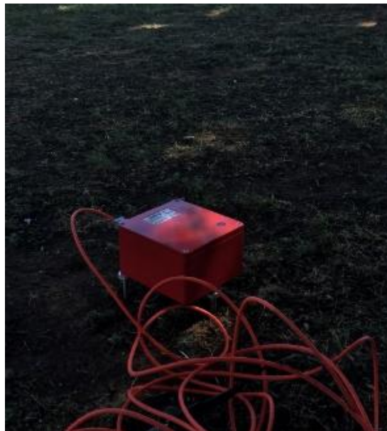
Figura 4: Sismógrafo triaxial SR04 – Geobox
