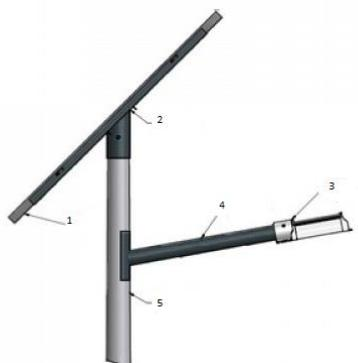
Paneles solares (1) montados sobre estructura de montaje (2) la cual deberá ser regulable en azimut en terreno e inclinación fija (ver punto 7.3.4). La luminaria (3) se montará al poste a través de un brazo (4) soldado o apernado al poste, poste de acero galvanizado en caliente (5).
