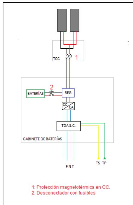
Figura N° 1: Diagrama referencial de un sistema fotovoltaico
