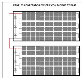
*Figura N° 2: paneles en horizontal*
