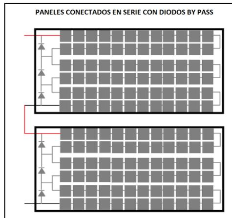
Figura N° 2: módulos en horizontal
