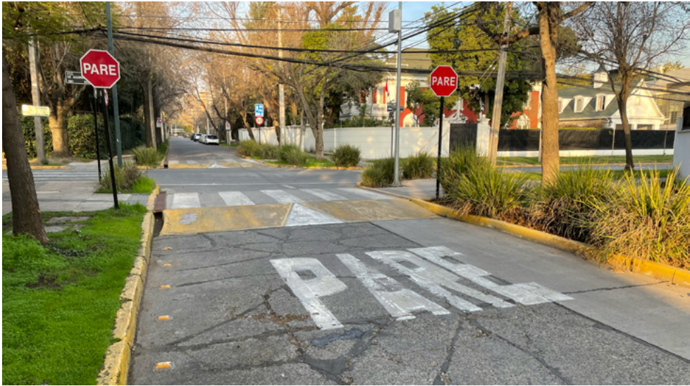
Figura 20: Acera continua con drenaje de aguas lluvias. Funciona como umbral de acceso a una ZTC con límite de 30k/h.
