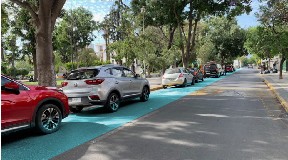
Figura 7: El estacionamiento en zona prohibida al costado izquierdo (demarcación amarilla) evidencia el remanente de calzada. Es probable que una calzada de de 4,5 m baste para acoger el flujo vehicular eventual y sin transporte público. Se presenta una oportunidad para ampliar la acera.
